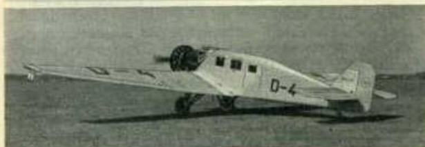
Abb. 4 bis 6. Verkehrsflugzeug „Junkers W 34“. Baujahr 1926. Sechs Fluggäste. Reisegeschwindigkeit 200 km/h.
