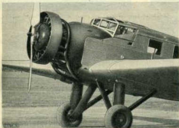
Abb. 16. Sternmotor des Baumusters W 34, mittels Townendrings verkleidet. Luftwiderstand groß, da aerodynamisch guter Übergang zum Rumpf fehlt.
