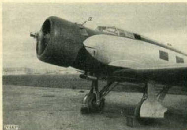
Abb. 17. Sternmotor des Baumusters Ju 160, mittels N.A.C.A.-Haube verkleidet. Luftwiderstand klein. Der Austritt der heißen Kühlluft aus der Haube wird nach unten abgelenkt, damit ein übermäßiges Aufheizen der Führer- und Fahrgasträume vermieden wird.
