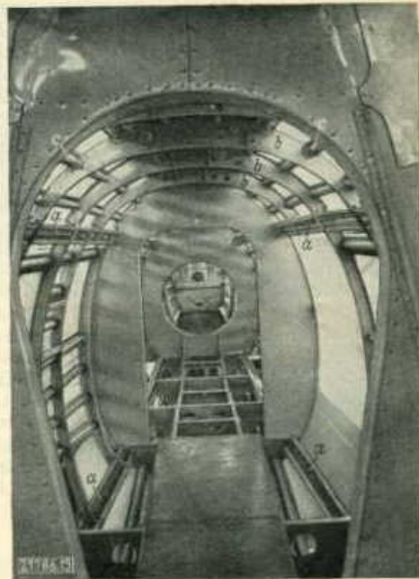
Abb. 13. Rumpfaufbau des Baumusters Ju 160.
